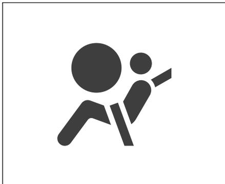
Контрольная лампа подушки безопасности контролирует состояние системы подушек безопасности, цепи системы предварительного натяжения ремня и все связанные цепи. Когда пусковой выключатель находится в положении ON, система сначала выполняет самопроверку, и сигнальная лампа подушки безопасности загорается на несколько секунд, а затем гаснет, указывая на то, что система находится в исправном рабочем состоянии. При
