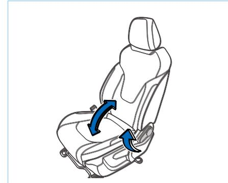
Ваш автомобиль оборудован ручкой регулировки угла наклона спинки сиденья, расположенной снаружи сиденья.
