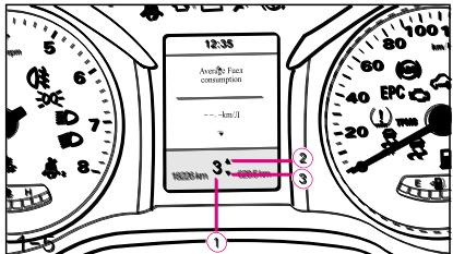
Индикатор переключения передач (GSI) показывает подсказки о переключении передач для автомобиля, оборудованного механической коробкой передач, чтобы помочь водителю снизить расход топлива и повысить экономичность вождения. GSI будет отображать оптимальную передачу и статус переключения передач, которые соответствуют поведению большинства водителей при любых условиях. Это не влияет на
