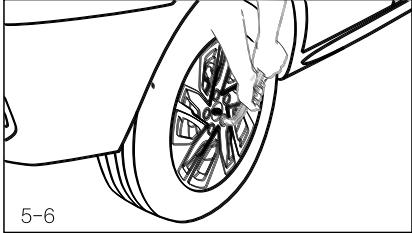
4. С помощью специального баллонного ключа открутите колесные гайки на несколько оборотов.
