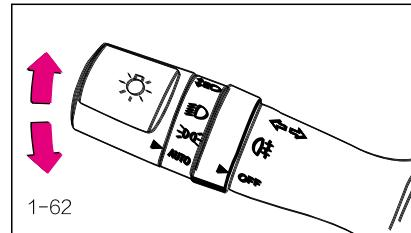
Указатель поворота срабатывает только при включенном зажигании. Если необходимо повернуть налево, поверните ручку управления переключателем света фар вниз. Если нужно повернуть направо, поверните ручку управления переключателем света фар вверх. Соответствующий индикатор на комбинации приборов в этот момент
