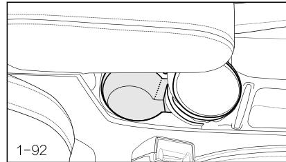
Подстаканник для переднего пассажира расположен за рычагом коробки передач. Будьте осторожны при использовании подстаканника, если пролитая жидкость нагреет корпус, вы или другие пассажиры в салоне можете обжечься. Внутри подстаканника можно разместить только закрытую емкость. Два подстаканника могут быть размещены до и после перемещения пепельницы, задний подстаканник предназначен для
