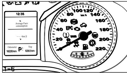
Указатель уровня топлива показывает текущий приблизительный объем топлива в топливном баке. Он более точен, когда автомобиль движется по ровной дороге, и стрелка указателя уровня топлива может подпрыгивать во время торможения, ускорения и при повороте или во время движения по неровным дорогам, и будет нормально указывать уровень, когда автомобиль движется стablyно. Дисплей работает, когда ключ зажигания включен.
