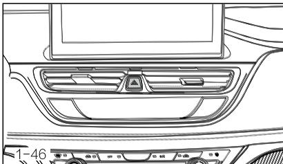
Функция оттаивания (отпотевания) заднего стекла работает только при заведенном двигателе. Индикатор на панели приборов при включении переключателя оттаивания (отпотевания) заднего стекла. Примерно через 20 минут оттаивание (отпотевание) стекла автоматически отключится. Оттаивание (отпотевание) заднего стекла также можно отключить раньше, повторно нажав переключатель.
