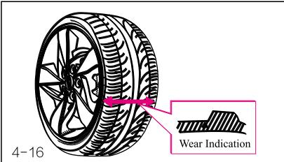
Проверьте индикатор износа шины, чтобы определить, когда следует заменить шину на новую. Когда поверхность шины изношена до того остатка в 2,2 мм или меньше, появится индикатор износа шины.
