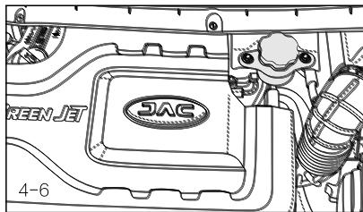
Тормозную жидкость в баке с тормозной жидкостью следует регулярно проверять.
