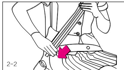
Вытяните ремень безопасности из втягивающего механизма, вставьте металлическую пластину с язычком в пряжку, вы услышите щелчок. После регулировки поясного ремня он автоматически растягивается и втягивается, старайтесь разместить его на бедрах.
