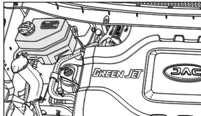
При перегреве двигателя запрещается использовать охлаждающую жидкость с концентрацией более 60% и менее 35%, в противном случае можно повредить систему охлаждения двигателя. При добавлении или замене охлаждающей жидкости выбирайте подходящую концентрацию в соответствии со следующей таблицей:
