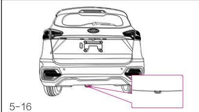
Особое внимание следует уделять буксировке автомобиля. При таком методе буксировки внутри автомобиля должен находиться водитель для управления и торможения автомобилем. Такой метод буксировки можно использовать только на твердой дороге, на короткое расстояние и при низкой скорости, при этом колеса, оси, система привода, рулевое колесо и тормоз должны быть в хорошем рабочем состоянии.
