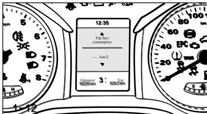
Расход запаса топлива основан на км / л в качестве единицы измерения, чтобы показать средний расход топлива за цикл движения. Если двигатель не работает более 2 часов, расход топлива за поездку автоматически сбрасывается. После очистки записи на дисплее отображается расчетный расход запаса топлива, когда автомобиль находится на расстоянии 100 м или меньше, после 100 м пути отображается как км / л.
