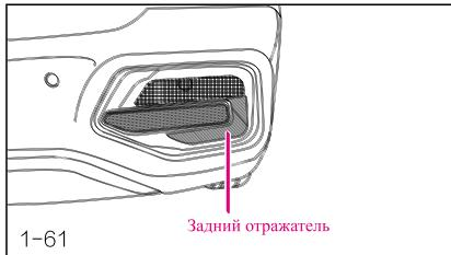
В заднем отражателе нет источника света, и отражает свет в основном используется для отражения света на внутренних узорах, чтобы предупредить задние автомобили.
