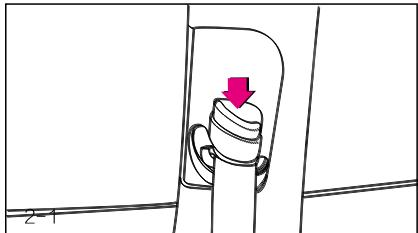
Высота ремня безопасности переднего сиденья регулируется с помощью крепежного основания. Отрегулируйте ремень безопасности так, чтобы он проходил через плечо и грудь, а не через шею. Если ремень безопасности установлен слишком близко к шее, наиболее эффективная защита может не сработать. Чтобы отрегулировать высоту крепежного основания ремня,
