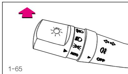
Поверните цилиндрический поворотный переключатель на конце ручки управления переключателем света фар в положение и потяните ручку управления переключателем света фар вперед до тех пор, пока не услышите щелчок, чтобы включить дальний свет фар. Фары станут светить намного ярче, и на панели приборов загорится индикатор дальнего света. Чтобы снова переключиться на фары головного света, потяните ручку управления переключателем света фар назад.
