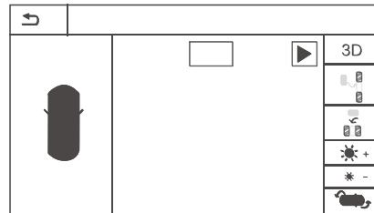
Экранный дисплей левого обзора (в режиме разделения экрана левая сторона – это панорамный экран, а правая – одноканальное левое видеоизображение).
