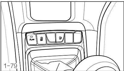
**Запуск (Start):** Во включенном состоянии питания включите передачу заднего хода или нажмите переключатель на панели управления, система помощи при парковке включена, а дисплей навигационного хоста вызывает интерфейс отображения радара.
