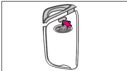
2. Вставьте прямую отвертку в отверстие для разборки, чтобы приподнять верхний корпус, а затем откройте корпус вдоль зазора.
