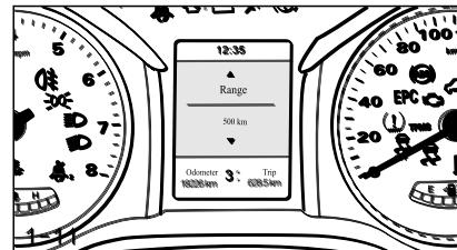
Диапазон используется для отображения текущего запаса хода топливного бака.
