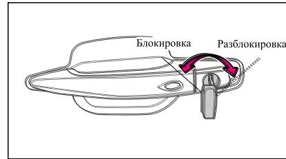
Когда дверь запирается на ключ снаружи автомобиля, четыре двери блокируются после того, как ключ был вставлен и повернут против часовой стрелки.
