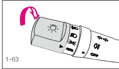
Поворачивайте цилиндрообразный поворотный переключатель на конце ручки управления переключателем света фар для управления светом фар. Поверните переключатель в положение  $\Rightarrow\Leftarrow$ , чтобы включить габаритные огни, фонарь освещения номерного знака, подсветку приборов и подсветку центральной консоли. Поверните переключатель в положение  $\equiv\bullet$ , чтобы включить фары головного света.
