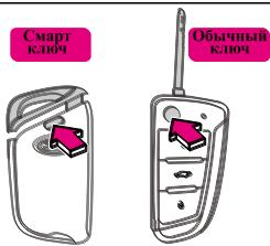
**Смарт ключ:** чтобы вынуть механический ключ, нажмите кнопку разблокировки и выньте ключ.
