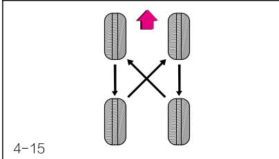
Не используйте при перестановке компактное запасное колесо. После перестановки шин отрегулируйте давление в передних и задних шинах в соответствии с информацией о шинах и нагрузке на этикетке. Убедитесь, что все колесные гайки затянуты правильно.
