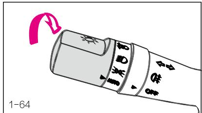
При переводе переключателя в положение AUTO фары включаются автоматически, когда становится темно. И наоборот, фары головного света автоматически выключаются при дневном свете.
