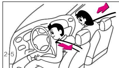
На передних сиденьях вашего автомобиля установлено устройство предварительного натяжения. Устройство может обеспечить безопасность водителя и переднего пассажира при серьезном столкновении.
