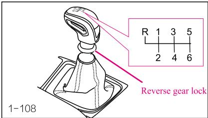
На рычаге механической коробки передач помечены положения каждой передачи.
