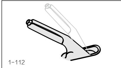
Чтобы припарковаться потяните ручку стояночного тормоза вверх. Достаточно лишь немного поднять ручку и нажать кнопку блокировки, а затем полностью опустить ее для отпускания стояночного тормоза, когда на приборной панели погаснет световой индикатор.
