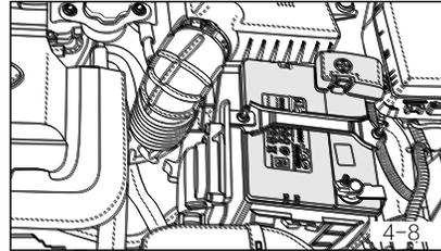
Ваш автомобиль оснащен необслуживаемым аккумулятором. Если необходимо заменить аккумулятор на новый, его номер должен совпадать с номером детали на этикетке оригинального аккумулятора. Обратитесь к разделу "Обзор моторного отсека" для определения расположения аккумулятора.
