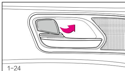
Сначала поверните ключ зажигания в салоне в положение «ЛОСК», извлеките ключ, нажмите кнопку блокировки ручки, потяните за наружную ручку двери и закройте двери, чтобы заблокировать их.
