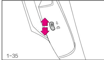
Две задние двери данного автомобиля оборудованы предохранительными замками для защиты детей.
