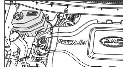
При перегреве двигателя запрещается использовать охлаждающую жидкость с концентрацией более 60% и менее 35%, в противном случае можно повредить систему охлаждения двигателя. При добавлении или замене охлаждающей жидкости выбирайте подходящую концентрацию в соответствии со следующей таблицей:
