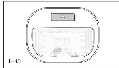
Потолочная лампа находится под управлением трех-блочных переключателей фар, но когда фары не горят, вы можете вручную нажать кнопку на потолочной лампе, чтобы отдельно включить потолочную лампу.
