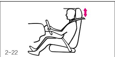
Высота подголовника регулируется в соответствии с ростом пассажира/водителя и положением головы. Правильно отрегулированная высота подголовника вместе с ремнем безопасности может обеспечить эффективную защиту.
