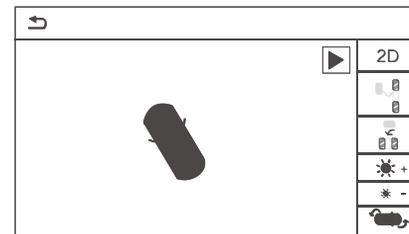
Когда отобразится панорамный 3D дисплей, потяните переключатель поворота вправо, чтобы переключить экран на панорамный 3D дисплей правого обзора и одноканальное правое видеоизображение. При выключении сигнала переключателя правого поворота экран возвращается к предыдущему панорамному 3D дисплею.
