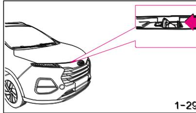
Перед тем как закрыть капот двигателя, слегка приподнимите капот двигателя, извлеките упор и вставьте его в исходный зажим, медленно опустите капот двигателя и дайте ему свободно опуститься до фиксации на расстоянии примерно 30 см от положения блокировки. Наконец, слегка приподнимите капот двигателя вверх, чтобы проверить, что капот закрыт и заблокирован. Если капот двигателя не закрыт и не заблокирован, повторите вышеуказанные действия.
