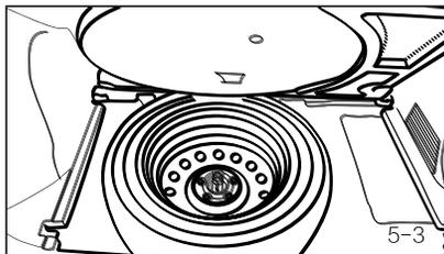
Запасное колесо фиксируется в багажнике.
