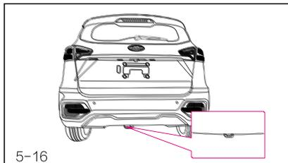
Особое внимание следует уделять буксировке автомобиля. При таком методе буксировки внутри автомобиля должен находиться водитель для управления и торможения автомобилем. Такой метод буксировки можно использовать только на твердой дороге, на короткое расстояние и при низкой скорости, при этом колеса, оси, система привода, рулевое колесо и тормоз должны быть в хорошем рабочем состоянии.
