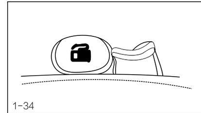
Откройте крышку горловины топливного бака через ручку открывания крышки топливного бака рядом с сиденьем передней левой двери, затем отвинтите крышку горловины топливного бака против часовой стрелки.
