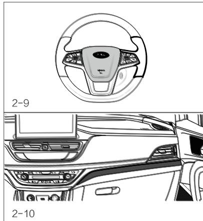
Данная модель оборудована системой SRS с отметкой SRS AIRBAG на ведущем колесе и передней панели приборов со стороны переднего пассажира. Подушка безопасности
