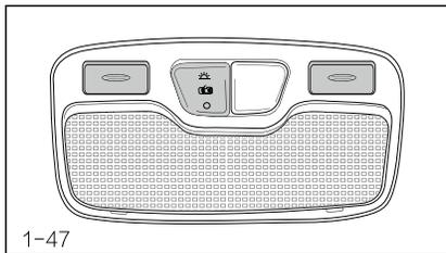
Световой луч потолочной лампы удобен для чтения в ночное время или как освещение для водителя и пассажиров.
