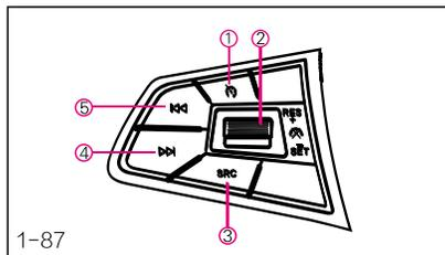
② Функция телефона доступна только для моделей, оснащенных телефонным модулем с функцией Bluetooth и системами распознавания голоса. Когда система распознавания голоса включена, нажмите эту кнопку, чтобы завершить или отклонить вызов. Нажмите эту кнопку для отключения звука во время работы информационно-развлекательной системы.
