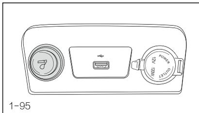
Прикуриватель можно использовать только в том случае, если замок зажигания находится в положении "ACC" или "ON".
