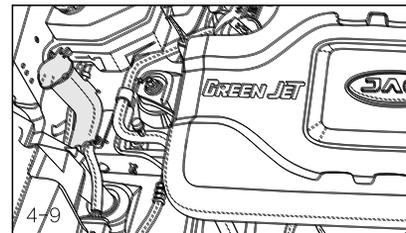
Перед началом движения убедитесь, что уровень жидкости стеклоомывателя достаточен и заполнен надлежащий раствор в соответствии с настоящим руководством. В холодную погоду запрещено заправлять более трех четвертей всего объема бака для жидкости стеклоомывателя.
