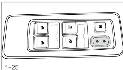
Кнопка управления дверным замком на стороне водителя позволяет управлять замком четырех дверей. Нажмите переднюю часть кнопки управления вниз, чтобы заблокировать четыре двери; нажмите заднюю часть кнопки управления вниз, чтобы разблокировать четыре двери.
