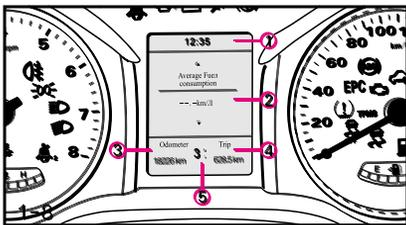
В дисплее используется точно-матричный ЖК-дисплей с диагональю 3,5 дюйма.
