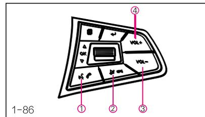
① Эта кнопка применяется только к моделям, оснащенным телефонным модулем с функцией Bluetooth и системами распознавания голоса. Когда телефонный модуль с функцией Bluetooth не активирован, нажмите эту кнопку, чтобы запустить систему распознавания голоса; когда телефонный модуль с функцией Bluetooth включен и есть доступ к телефону, нажмите эту кнопку, чтобы подключить телефон.
