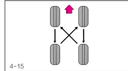
Не используйте при перестановке компактное запасное колесо. После перестановки шин отрегулируйте давление в передних и задних шинах в соответствии с информацией о шинах и нагрузке на этикетке. Убедитесь, что все колесные гайки затянуты правильно.
