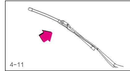
1. Поднимите рычаг стеклоочистителя, чтобы отодвинуть его от лобового стекла.
