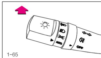
Поверните цилиндрикообразный поворотный переключатель на конце ручки управления переключателем света фар в положение  $\equiv \text{D}$  и потяните ручку управления переключателем света фар вперед до тех пор, пока не услышите щелчок, чтобы включить дальний свет фар. Фары станут светить намного ярче, и на панели приборов загорится индикатор дальнего света. Чтобы снова переключиться на фары головного света, потяните ручку управления переключателем света фар назад.
