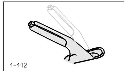
Чтобы припарковаться потяните ручку стояночного тормоза вверх. Достаточно лишь немного поднять ручку и нажать кнопку блокировки, а затем полностью опустить ее для отпускания стояночного тормоза, когда на приборной панели погаснет световой индикатор. Обязательно потяните вверх ручку стояночного тормоза, иначе это может вызвать самопроизвольное скатывание на склоне.
