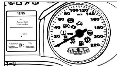
Указатель уровня топлива показывает текущий приблизительный объем топлива в топливном баке. Он более точен, когда автомобиль движется по ровной дороге, и стрелка указателя уровня топлива может подпрыгивать во время торможения, ускорения и при повороте или во время движения по неровным дорогам, и будет нормально указывать уровень, когда автомобиль движется стабильно. Дисплей работает, когда ключ зажигания включен.
