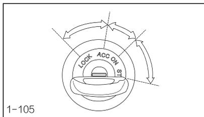
Замок зажигания расположен на правой стороне рулевой колонки под рулевой колонкой. Переключатель имеет четыре положения, а именно:
