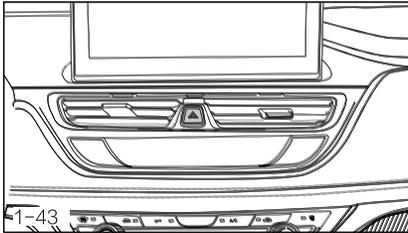
Выключатель лампы аварийной сигнализации имеет треугольную отметку на выключателе, как показано выше.
