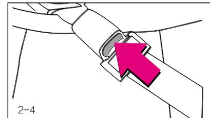
Удерживая пряжку, нажмите кнопку разблокировки, чтобы расстегнуть ремень безопасности. После разблокировки ремень автоматически втягивается, в противном случае проверьте, не перекручен ли он, а затем повторите попытку.
