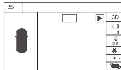
Экранный дисплей левого обзора (в режиме деления экрана левая сторона – это панорамный экран, а правая – одноканальное левое видеоизображение).
