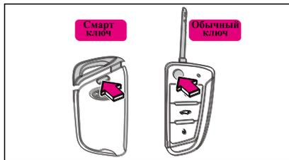
Смарт ключ: чтобы вынуть механический ключ, нажмите кнопку разблокировки и выньте ключ.
