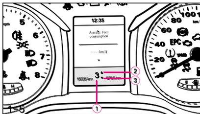
Индикатор переключения передач (GSI) показывает подсказки о переключении передач для автомобиля, оборудованного механической коробкой передач, чтобы помочь водителю снизить расход топлива и повысить экономичность вождения. GSI будет отображать оптимальную передачу и статус переключения передач, которые соответствуют поведению большинства водителей при любых условиях. Это не повлияет на
