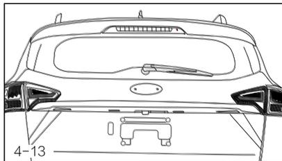
Чтобы заменить заднюю щетку стеклоочистителя, поднимите рычаг стеклоочистителя заднего лобового стекла, чтобы снять и заменить щетку.
