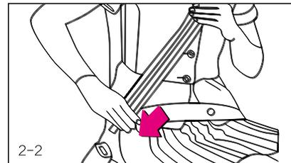
Вытяните ремень безопасности из втягивающего механизма, вставьте металлическую пластину с язычком в пряжку, вы услышите щелчок. После регулировки поясного ремня он автоматически растягивается и втягивается, старайтесь разместить его на бедрах.
