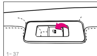
Открытие: нажмите выключатель вниз, оконное стекло откроется, для остановки отпустите кнопку; Закрывание: нажмите выключатель вверх, оконное стекло закроется, для остановки отпустите кнопку.
