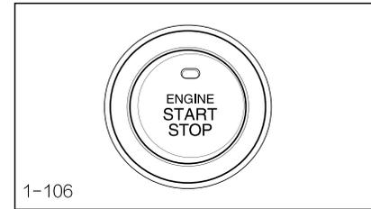
Возьмите с собой смарт-ключ, чтобы разблокировать автомобиль, установите рычаг переключения передач в положение Р, нажмите педаль тормоза. Когда индикатор замка зажигания загорится зеленым, нажмите на него, запустите двигатель и отпустите замок зажигания.
