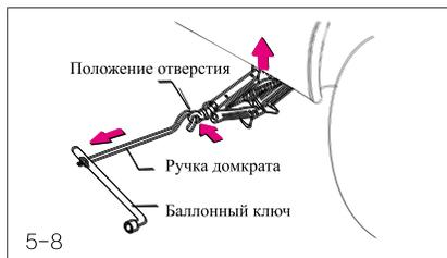
9. Поворачивайте ручку домкрата по часовой стрелке, чтобы поднять автомобиль, до тех пор, пока головка не войдет в соответствующее отверстие, а шина не оторвется от земли на 3 см.
