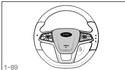
Нажмите на логотип клаксона на рулевом колесе, прозвучит звуковой сигнал динамика. Регулярно проверяйте рабочее состояние динамика, чтобы убедиться, что он работает правильно.
