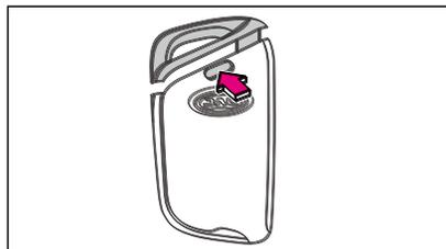
2. Вставьте прямую отвертку в отверстие для разборки, чтобы приподнять верхний корпус, а затем откройте корпус вдоль зазора.
