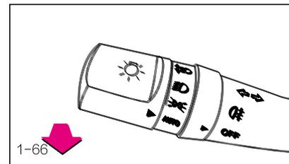
Чтобы фары начали мигать, осторожно поверните ручку управления переключателем света фар в сторону водителя. Затем отпустите ее. Фары головного света в это время включатся, а затем погаснут. Фары головного света также мигают, даже если ручка управления переключателем света фар находится в положении «OFF». Если вы потянете
