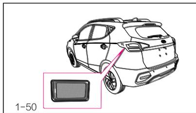
Подсветка багажника расположена над внутренней частью багажного отделения, и при открытии крышки багажного отсека загорается соответствующая подсветка багажного отделения. После того, как вы закроете крышку багажного отделения, подсветка багажного отделения погаснет.
