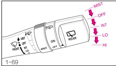
Стеклоочистителем и омывателем можно управлять с помощью комбинационного переключателя. Комбинационный переключатель управления режимом стеклоочистителя переднего ветрового стекла выглядит следующим образом: Перемещение стеклоочистителя - Переместите ручку комбинационного переключателя вверх к блоку "MIST",
