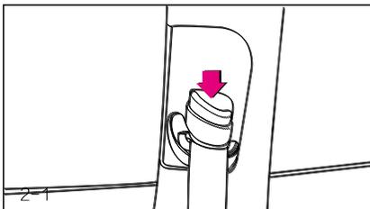
Высота ремня безопасности переднего сиденья регулируется с помощью крепежного основания. Отрегулируйте ремень безопасности так, чтобы он проходил через плечо и грудь, а не через шею. Если ремень безопасности установлен слишком близко к шее, наиболее эффективная защита может не сработать. Чтобы отрегулировать высоту крепежного основания ремня,
