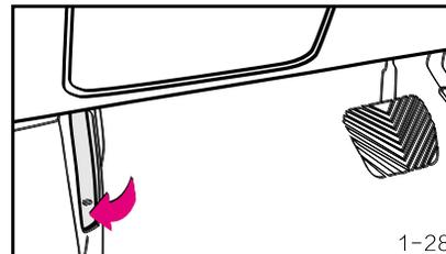
Рычаг открывания капота расположен слева внизу на приборной панели водителя.
