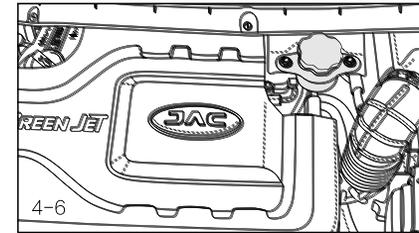
Тормозную жидкость в бачке с тормозной жидкостью следует регулярно проверять. Уровень всегда должен находиться между отметками «MAX» и «MIN». Во время движения из-за износа и автоматической регулировки фрикционных дисков тормозов уровень жидкости немного снизится, что является нормальным явлением.
