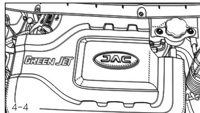
Если уровень моторного масла близок к нулю или ниже отметки MIN, моторное масло следует незамедлительно долить. Уровень масла ни при каких обстоятельствах не должен превышать отметку на щупе. В противном случае масло будет вливаться в систему впуска воздуха через вентиляционное отверстие коленчатого вала и выбрасываться в воздух через выхлопную систему.
