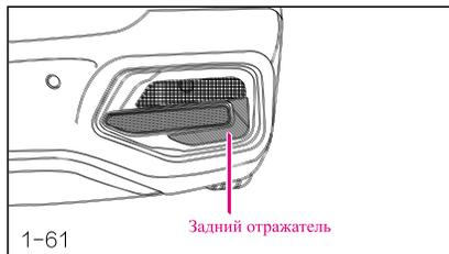
В заднем отражателе нет источника света, и отражатель в основном используется для отражения света на внутренних узорах, чтобы предупредить задние автомобили.
