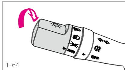
При переводе переключателя в положение AUTO фары включаются автоматически, когда становится темно. И наоборот, фары головного света автоматически выключаются при дневном свете.
