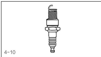
Свечи зажигания следует заменять в рамках цикла технического обслуживания ЯС.
