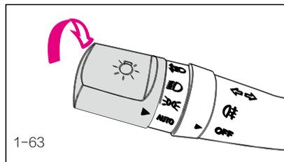
Поворачивайте цилиндрический поворотный переключатель на конце ручки управления переключателем света фар для управления светом фар. Поверните переключатель в положение  $\equiv \square$ , чтобы включить габаритные огни, фонарь освещения номерного знака, подсветку приборов и подсветку центральной консоли. Поверните переключатель в положение  $\equiv \square$ , чтобы включить фары головного света.
