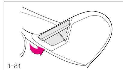
Ваш автомобиль имеет регулировочную ручку наклона спинки сиденья, расположенную снаружи сиденья.
