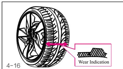
Проверьте индикатор истирания шины, чтобы определить, когда следует заменить шину на новую. Когда поверхность шины изношена до того остатка в 2,2 мм или меньше, появится индикатор истирания шины.
