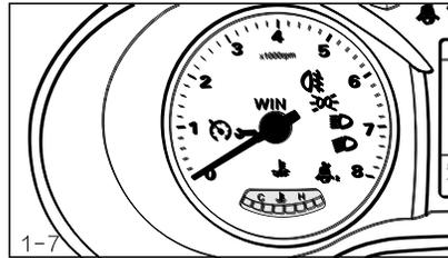
Индикатор температуры воды показывает температуру охлаждающей жидкости двигателя при включении зажигания. Датчик температуры воды должен отображаться в средней части диапазона, при исправной работе автомобиля. Когда индикатор температуры воды переходит на семерку и загорается индикатор, температура охлаждающей жидкости двигателя превышает нормальное
