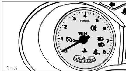
Тахометр отображает число оборотов двигателя в минуту (об/мин). Диапазон шкалы тахометра составляет 0-8000 об/ мин, и индикатор переходит в красную зону, когда частота вращения двигателя превышает 6200 об/мин. Двигатель будет быстро изнашиваться и потреблять больше топлива при слишком высоких оборотах. Более низкие обороты делают двигатель более экономичным в большинстве случаев.
