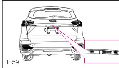
Фонарь освещения номерного знака используется для предоставления информации о вашем автомобиле пешеходам, находящимся за пределами вашего автомобиля в ночное время.
