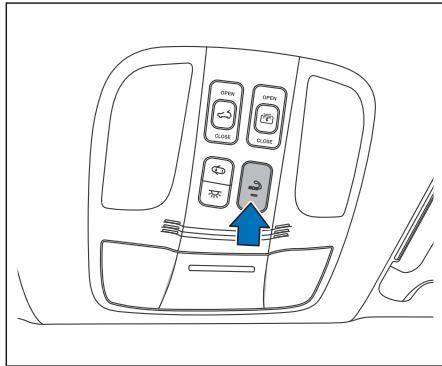
Когда автомобиль находится в чрезвычайной ситуации, нажмите и удерживайте переключатель в течение 3 секунд, чтобы набрать телефон экстренной помощи, и соответствующий интерфейс вызова появится на мультимедийном экране автомобиля.
