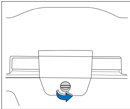
Треугольная предупредительная табличка размещена на задней откидной двери. Чтобы выпнуть треугольную предупредительную табличку, сначала поверните ручку крышки треугольной предупредительной таблички против часовой стрелки ( $90^\circ$ ), откройте крышку треугольной предупредительной таблички.
