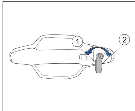
Сердцевина механического замка скрыта заглушкой. Вставьте ключ в отверстие и откройте крышку с небольшим усилием.
