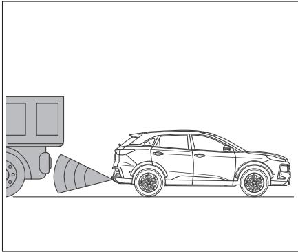
3. Датчик реверсивного радара не может обнаружить автомобиль с высоким кузовом.
