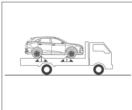
При буксировке грузовой платформой автомобиль должен быть надежно закреплен, как показано на рисунке.
