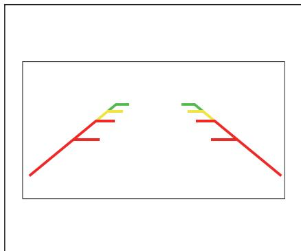
избежать несчастных случаев при движении задним ходом. При движении задним ходом необходимо обращать внимание на наличие препятствий на изображении. Также будет отображена вспомогательная линия заднего хода, чтобы помочь вам лучше понять расстояние между препятствием и автомобилем.
