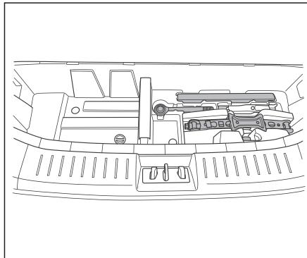
1. Откройте багажник и снимите покрытие пола.
