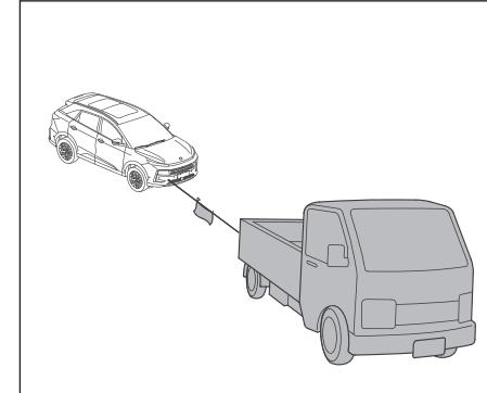
3. Переключите коробку передач в нейтральное положение и запустите двигатель. Если двигатель не запускается, переключите замок зажигания в положение ACC или ON.
