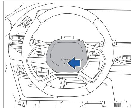
Клаксон будет работать независимо от положения пускового переключателя, при условии, что 12 В батарея не разрядится. При нажатии на клаксон, раздается звуковой сигнал. Отпустите клаксон и звуковой сигнал перестанет звучать.
