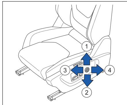
Сиденье обладает функцией "поясничной опоры". Если нажать кнопку "1", верхняя часть поясничной опоры медленно приподнимется и расшириться. Если отпустить кнопку, приподнятие остановится. Если нажать кнопку "2", нижняя часть поясничной опоры медленно приподнимется и расшириться и если отпустить кнопку, приподнятие остановится.
