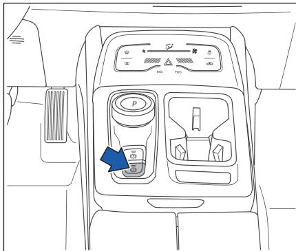
Функция AUTO HOLD автоматически включает стояночный тормоз после парковки, без нажатия водителем педали тормоза или рычага стояночного тормоза. Как только система обнаружит, что автомобиль больше не движется, AUTO HOLD запускается немедленно и стабилизирует автомобиль. В это время индикатор на комбинации приборов мигает, чтобы напомнить водителю, что работает функция AUTO
