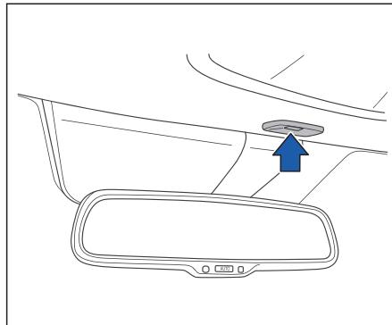
Если ваш автомобиль оборудован портом питания для видеорегистратора, питание может подаваться непосредственно от него на установленный видеорегистратор. Порт питания может автоматически регулировать подачу тока в соответствии с электрическим оборудованием, а максимальная мощность тока составляет 2,4 А.
