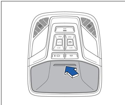
Ящик для очков расположен на потолочной консоли. Нажмите на верхнюю часть крышки, чтобы открыть ящик для очков.
