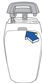
2. Используйте механический ключ для разблокировки замка (скрытая дверная блокировка)
