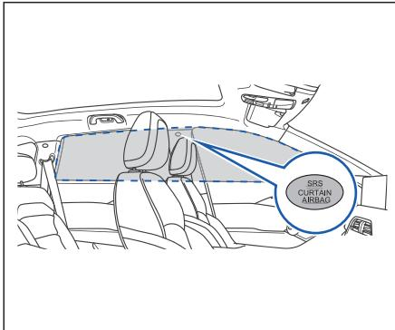
Боковые надувные занавесы устанавливаются над дверями с левой и правой стороны автомобиля, и для обозначения их монтажной позиции используется метка «AIRBAG». Когда автомобиль подвергается боковому удару, система запускает боковой надувной занавес на стороне столкновения, и боковой надувной занавес мгновенно раскрывается на высокой скорости, обеспечивая защиту людей на стороне столкновения.
