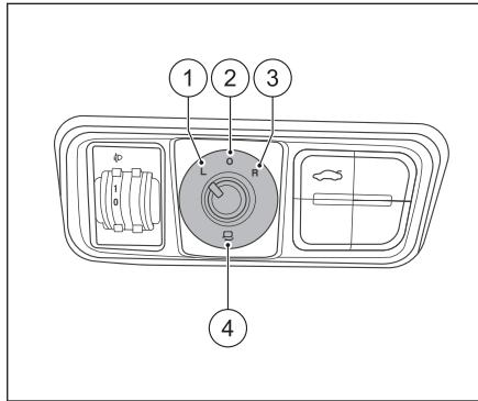
1. Положение L: регулировка левого зеркала заднего вида.
