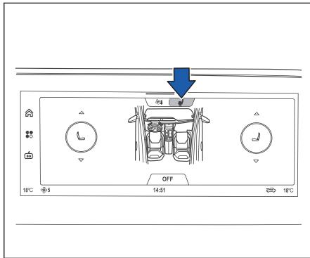
Установите пусковой переключатель в положение ON и нажмите на иконку обогрева сиденья водителя на мультимедийном дисплее, чтобы активировать функцию обогрева сиденья. Снова нажмите на иконку, чтобы отключить функцию обогрева сиденья. Пожалуйста, не включайте обогрев сидений в следующих ситуациях:
