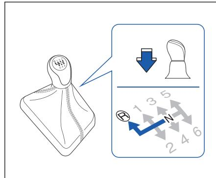
Как показано на рисунке, положение каждой передачи отмечено на рычаге переключения передач. Во время движения автомобиля последовательность переключения передач следующая:
