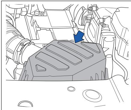
Воздушный фильтр можно чистить при проверке элемента воздушного фильтра. Заменяйте фильтрующий элемент в соответствии с интервалом времени, указанным в руководстве по техническому обслуживанию.
