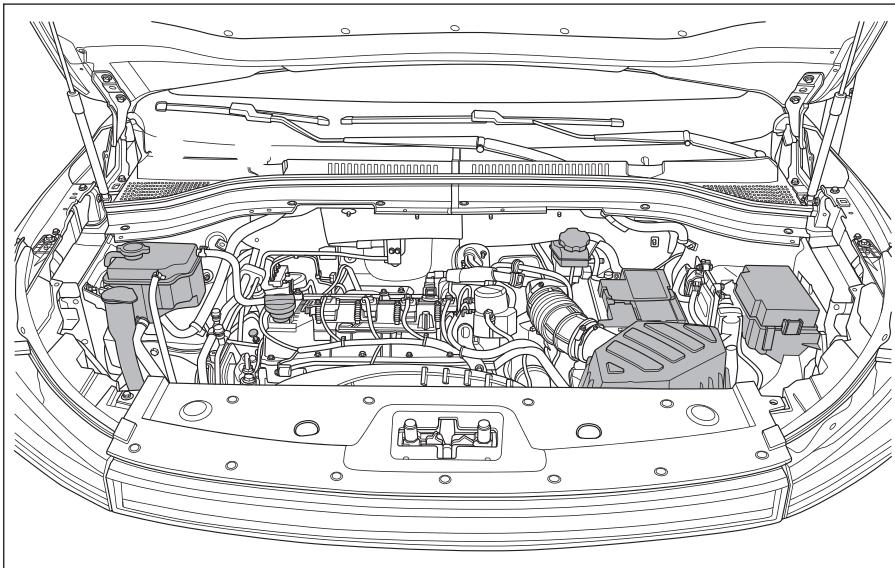
Бак системы охлаждения расположен с правой стороны моторного отсека, как показано на рисунке выше. Когда двигатель полностью охлажден, уровень охлаждающей жидкости должен
