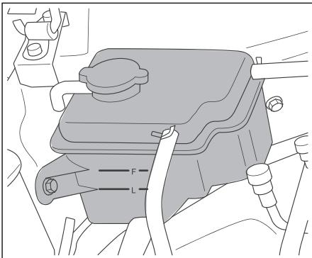
Охлаждающая жидкость, добавляемая в автомобиль, не только обеспечивает защиту от замерзания при низких температурах, но также защищает все детали из легкого сплава в системе охлаждения от коррозии, а также предотвращает образование осадка и значительно повышает температуру кипения охлаждающей жидкости. Если вам нужна более сильная защита от замерзания по климатическим причинам, обратитесь в официальный
