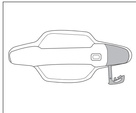
3. После вставки механического ключа в ядро замка, все двери и задняя откидная дверь могут быть заблокированы вращением против часовой стрелки и разблокированы вращением по часовой стрелке.
