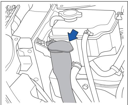
Всегда проверяйте уровень жидкости в очистителе лобового стекла. Если чистящей жидкости недостаточно, пополняйте ее вовремя. Чистящая жидкость может замерзнуть и расшириться в холодном климате. Не допускайте, чтобы уровень жидкости превышал три четверти после наполнения, в противном случае резервуар для жидкости для очистки лобового стекла может быть поврежден. Для лучшей очистки жидкость можно
