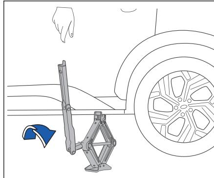
2. Разместите домкрат на ровной и твердой поверхности, отрегулируйте положение домкрата так, чтобы он находится непосредственно под опорной точкой на автомобиле, и соедините верхнюю часть домкрата с опорной точкой.
