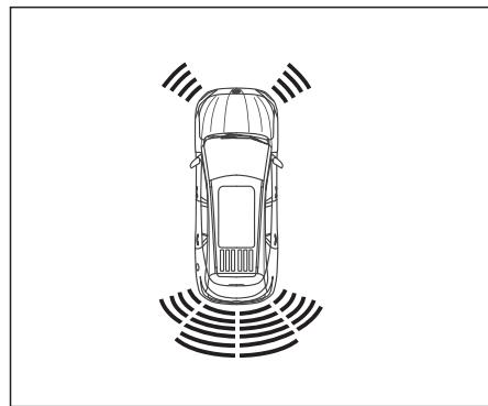
Система реверсивного радара имеет два вида, систему 4 радаров: в задней части автомобиля имеется 4 радара; систему 6 радаров: 2 радара в передней части автомобиля, 4 радара в задней части автомобиля.
