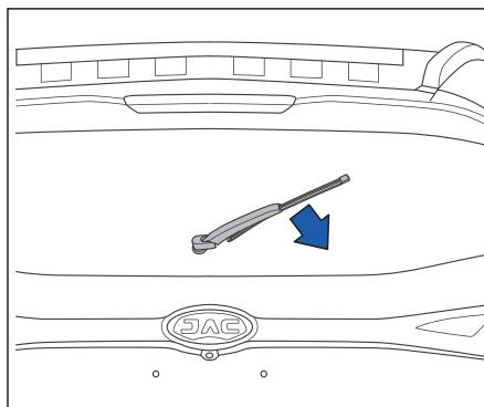
1. Поднимите рычаг стеклоочистителя и слегка вытяните щетку в направлении стрелки.
