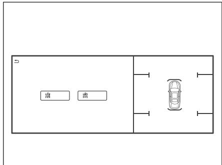
4. Управляйте автомобилем, чтобы система автоматически определила парковочное место с обеих сторон по направлению движения автомобиля. При поиске места для парковки на экране дисплея отображается информация о парковке в соответствующем месте.
