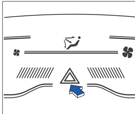
На выключателе лампы аварийной сигнализации есть треугольная метка, как показано на рисунке. Лампа аварийной сигнализации будет мигать, пока не разрядится аккумуляторная батарея 12В. Если вам необходимо остановиться или припарковаться в аварийной ситуации, включите лампу аварийной
