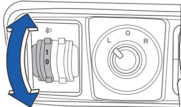
Когда пусковой переключатель находится в положении ВКЛ и фара включена, водитель может регулировать угол наклона оптической оси фары с помощью кнопки регулировки высоты фары. В зависимости от нагрузки транспортного средства и условий вождения, регулировка фары в правильном положении может улучшить видимость, не ослепляя встречное движение.
