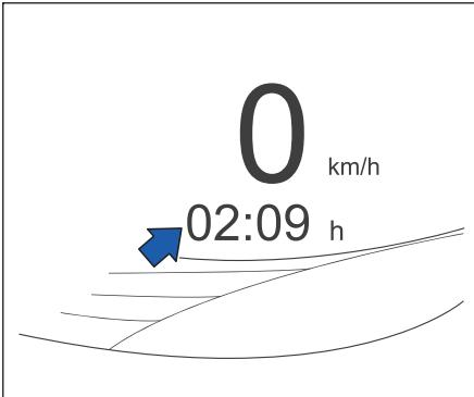
Данный прибор показывает ВРЕМЯ автомобиля в пути после последнего сброса значения. При проверке двигателя время в пути суммируется. При остановке работы двигателя, отсчет времени останавливается. Время вождения автоматически сбрасывается после полного выключения комбинированного прибора.
