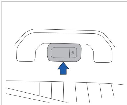
Лампы на двери находятся на обоих стенках. Для включения и выключения нажмите на кнопку. Когда переключатель передней потолочной лампочки включен, лампа на двери загорается при открытии любой двери.
