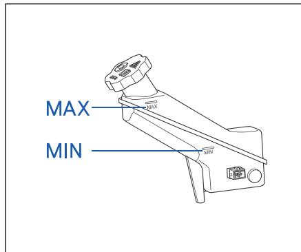
Регулярно проверяйте тормозную жидкость в баке тормозной жидкости. Уровень жидкости всегда должен быть между отметками MAX (максимум) и MIN (минимум). Во время движения изза износа и автоматической регулировки тормозных накладок уровень жидкости немного снизится, что является нормой. Если уровень жидкости в баке значительно падает или падает ниже
