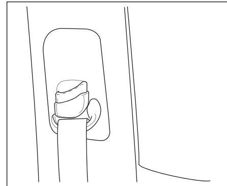
Нажмите кнопку спуска и отрегулируйте высоту плечевого ремня до наиболее подходящего положения. Отпустите кнопку и зафиксируйте крепление ремня безопасности на месте.
