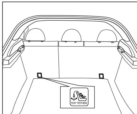
Верхний ремень соединен со стопорным кольцом на задней части заднего сиденья с помощью фиксирующего крючка.
