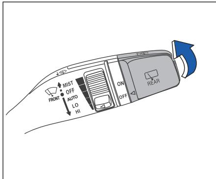
Когда стеклоочиститель находится в рабочем состоянии, поверните ручку управления заднего стеклоочистителя в положение ON, чтобы синхронно включить задний дворник.
