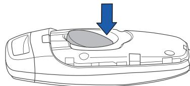
3. Извлеките батарею, нажав на перегородку батареи пальцем или отверткой.
