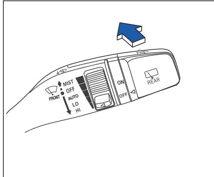
Осторожно потяните рычаг по направлению от водителя, и стеклоомыватель распылит чистящую жидкость на заднее лобовое стекло. В то же время стеклоочиститель будет продолжать работу на низкой скорости, пока рычаг управления стеклоочистителем не будет отпущен.
