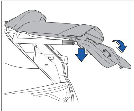
Потяните за внутреннюю ручку задней откидной двери или за край листового металла, чтобы опустить дверь вниз. Задняя откидная дверь может быть закрыта под действием собственного веса или небольшого усилия.
