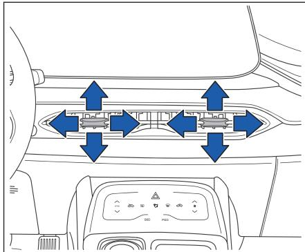
Перемещайте лопасть в центре вентиляционного отверстия в любом направлении, чтобы отрегулировать направление воздушного потока.
