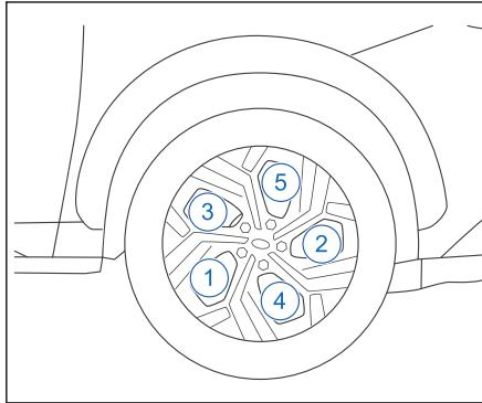
1. Удалите всю грязь или пыль с поверхности колес и ступиц.
