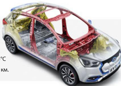
Кузов на **21%** состоит из высокопрочной стали и на **16%** из улучшенной высокопрочной стали, что обеспечивает надежную защиту водителя и пассажиров.
