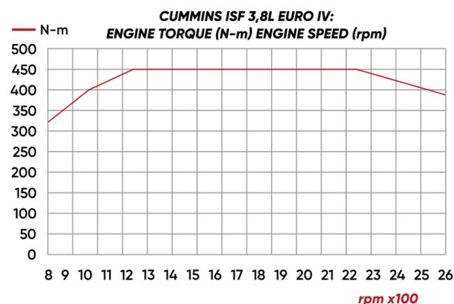
**Кривая крутящего момента:** (Н-м против об/мин): максимальный крутящий момент Cummins ISF 3,8Л возникает при относительно низких оборотах (1 200 об/мин) и продолжается по ровной линии вплоть до 2 200 об/мин. Диапазон составляет 1 000 об/мин (2 200 - 1 200 = 1 000) и составляет 45,45% от общего диапазона оборотов (1 000 / 2 200 = 0,4545). Идеальная кривая крутящего момента – ЭТО ИДЕАЛЬНАЯ ЭФФЕКТИВНОСТЬ, ИСПОЛЬЗУЕМАЯ В ТЕЧЕНИЕ ДОЛГОГО ВРЕМЕНИ НА УРОВНЕ ПИКА;
