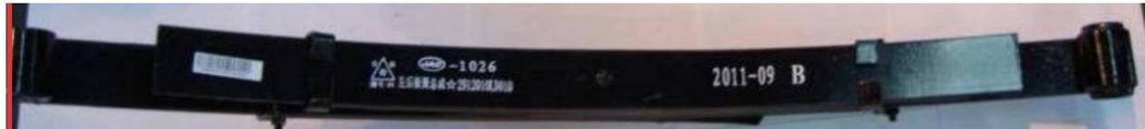
Пружина с помощью вторичной дробеструйной обработки повышает металлографическую чистоту, обеспечивая лучшую интенсивность и долговечность
